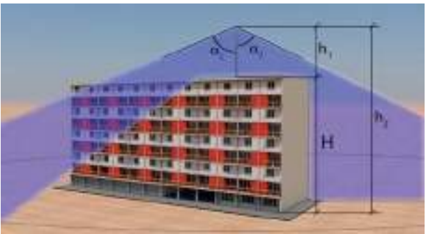
Fig. 7 – Volúmenes de protección para los ángulos α 1 y α 2 en función de las alturas h 1 y h 2 .
