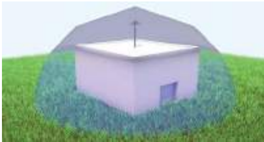
Fig. 4 – Volumen de protección de un PDC.
