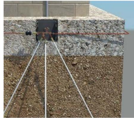
Fig. 13 - Sección transversal de una puesta a tierra.
